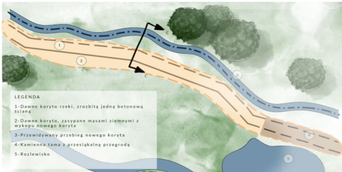
Rys. 4. Projekt przebudowy betonowego koryta rzeki
